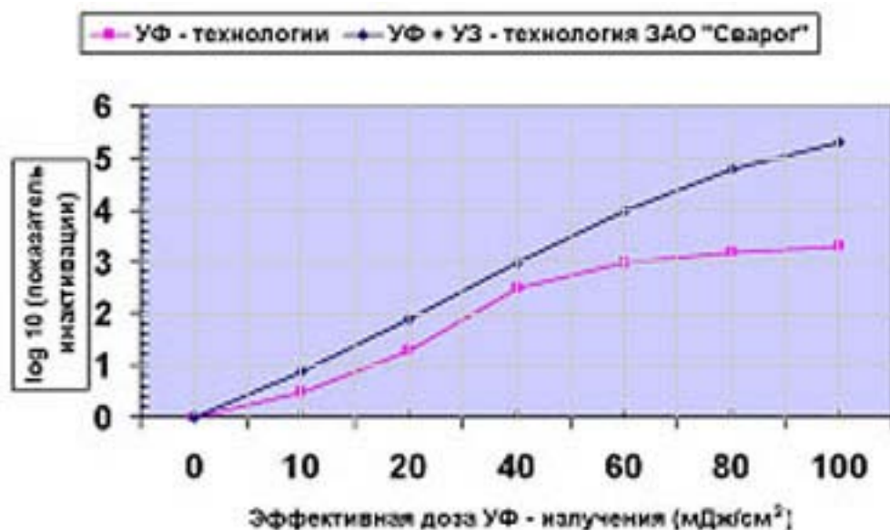
Рис.1 Логарифм показателя инактивации фага MS2 , как функция эффективной дозы ультрафиолетового излучения при обеззараживании питьевой воды и стоков ультрафиолетом
