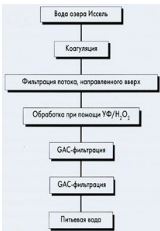
Рис. 8. Предполагаемая схема водообработки на предприятии.
